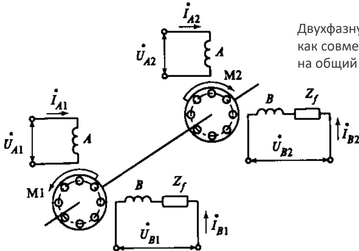
Двухфазную несимметричную машину можно представить как совместную работу двух двухфазных симметричных машин на общий вал
