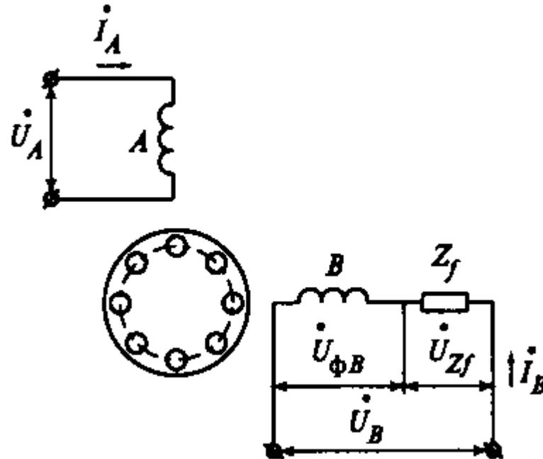
Напряжения фаз запишем как падения напряжения
